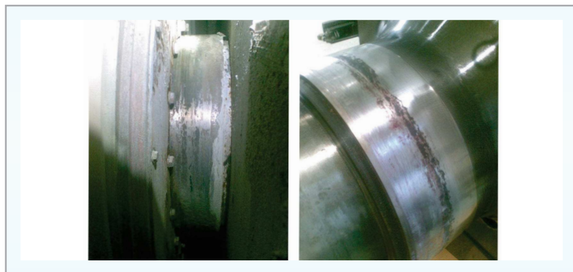
Figura 12: Suciedad en el eje del anillo rotativo.
