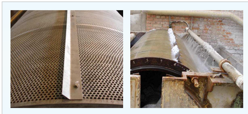
Figura 7: Fijación por regla transversal.
