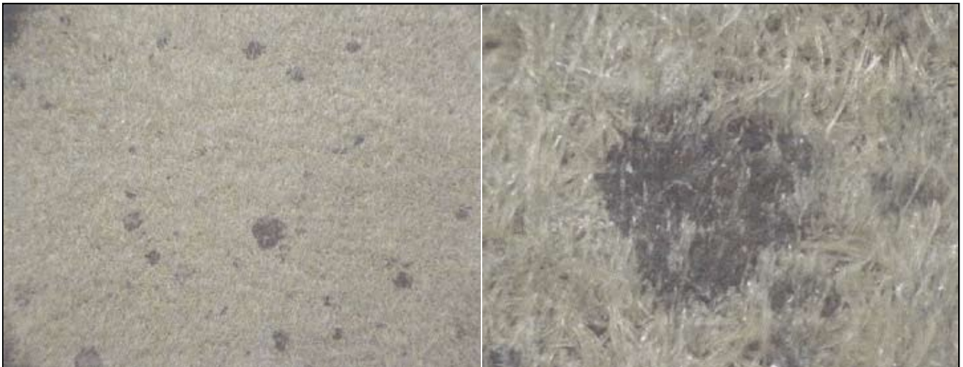
Material de obstrucción compuesto por pitch en la cara del fieltro
