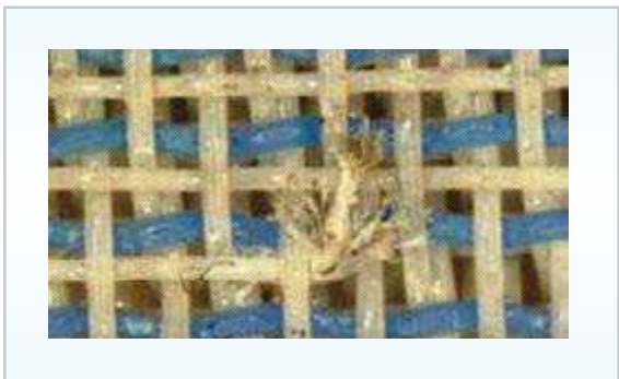
Imagen 3: Fibrilación de los hilos con regadera de alta presión
