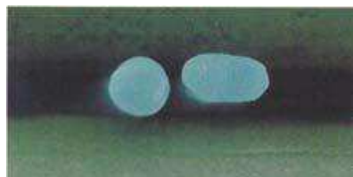
Fig. 2: A la izquierda, hilo monofilamento de sección transversal redondeada con 0,70mm de diámetro. A la derecha, hilo monofilamento perfilado con sección transversal de 44 x 88mm.
