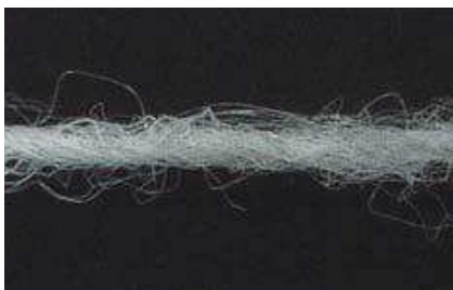
Fig. 8: Hilo hilado cuando se retira su torsión
