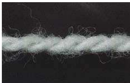
Fig. 7: Hilo hilado retorcido
