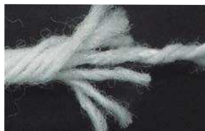
Fig. 9: Hilo hilado con alma astil
