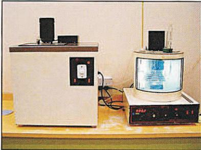
**Figura 6A** - Viscosímetro
