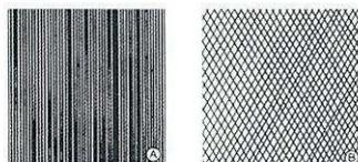
**Figura 13 – Frequência de oscilação correta à esquerda e incorreta à direita**
