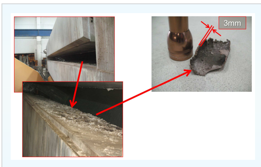
Figura 8: Exemplo de sujeira da máquina que pode adentrar o nipo.
