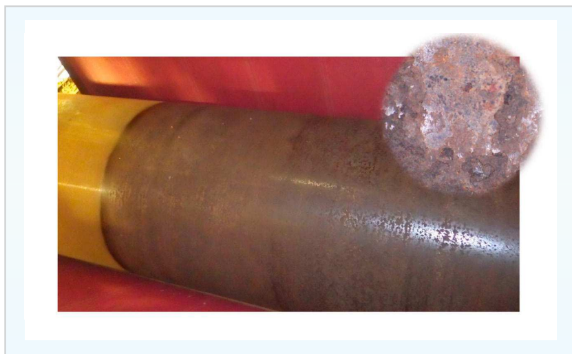
Figura 10: Foto de rolo guia em tela com corrosão.
