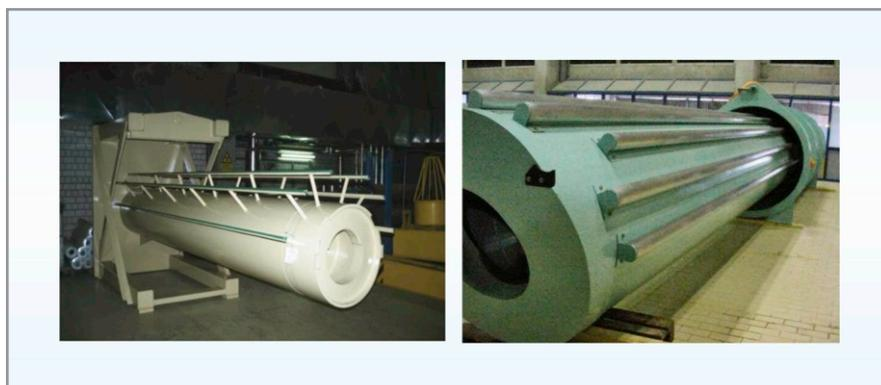
Fotos 2A e 2B: Os suportes devem ser limpos e inspecionados durante a instalação da nova manta
