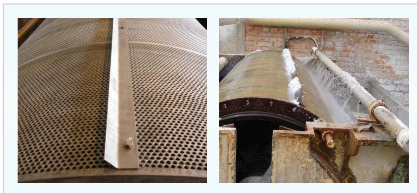
Figura 7: Fixação por régua transversal.
