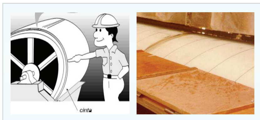
Figura 5: Fixação por cintas.
