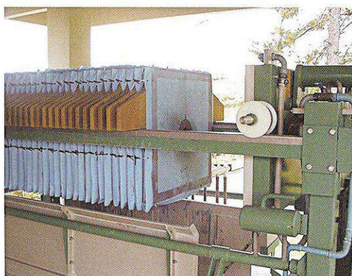
Tecido filtrante de Polipropileno usado em filtros prensa na prensagem de lodo biológico. O polipropileno é utilizado devido sua resistência química.
