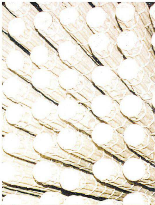
Mangas filtrantes de poliéster utilizadas em indústria cimenteira. O poliéster é utilizado devido sua resistência a abrasão.
