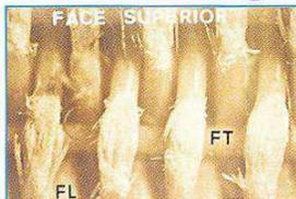
Aspecto físico de uma amostra de tela secadora que sofreu degradação química pela hidrólise. Nota-se que apenas os fios longitudinais (FL), no seu contato com o papel, sofrem hidrólise e os transversais permanecem intactos.
