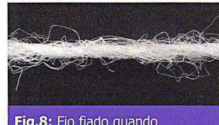
Fig.8: Fio fiado quando retira-se a sua torção.
