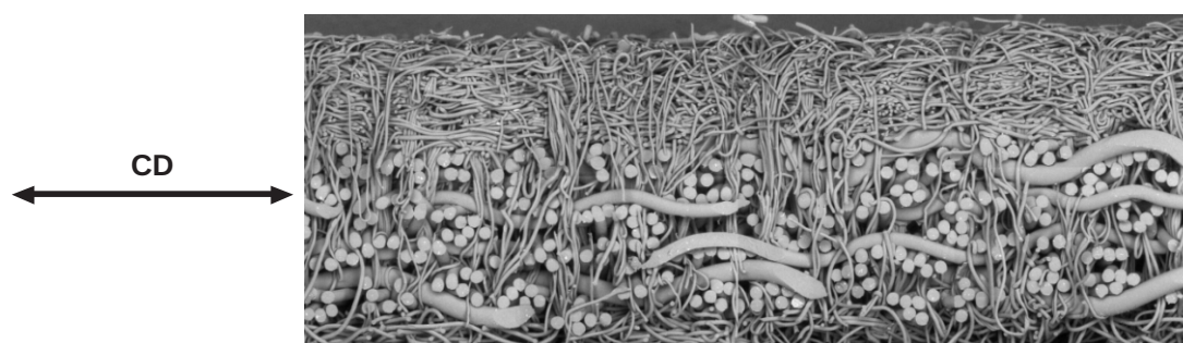
Figura 7: Seção transversal de um feltro acabado.
