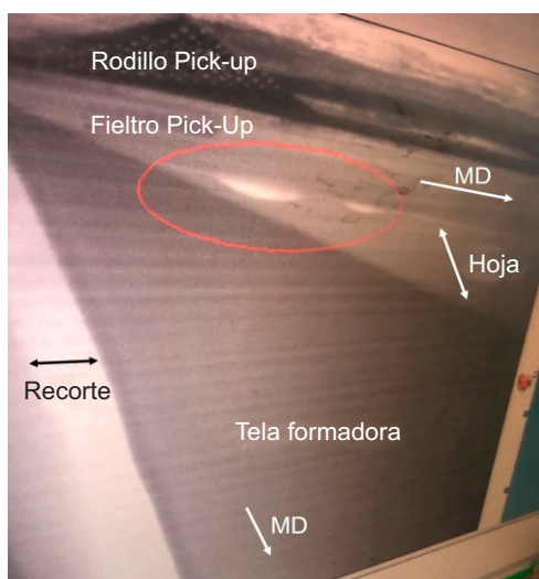
Figura 20: Desprendimiento de la hoja del fieltro pick-up.
