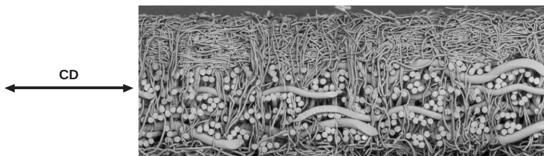
Figura 7: Sección transversal de un fieltro terminado
