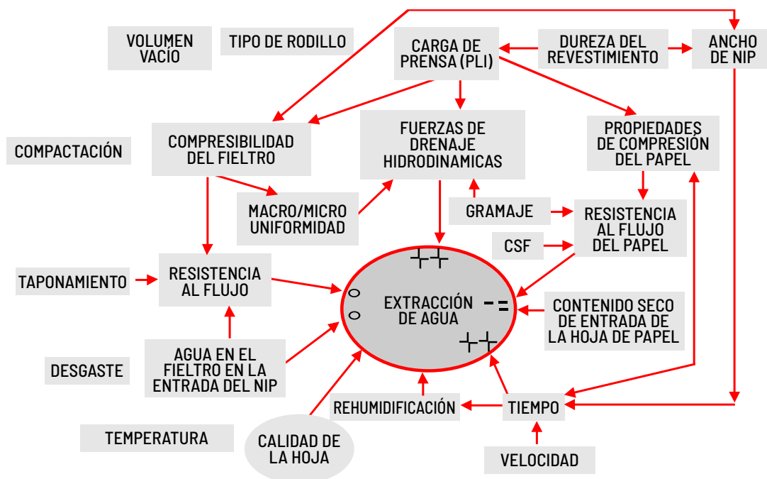
Figura 9: Muchos factores pueden controlar la eliminación de agua.
