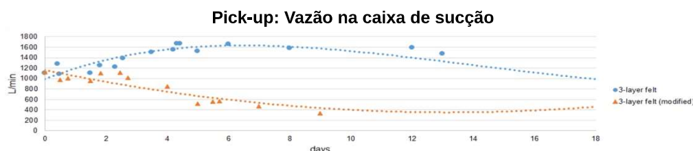
Figura 17: Vazão na caixa de sucção versus vida do feltro pick-up.
