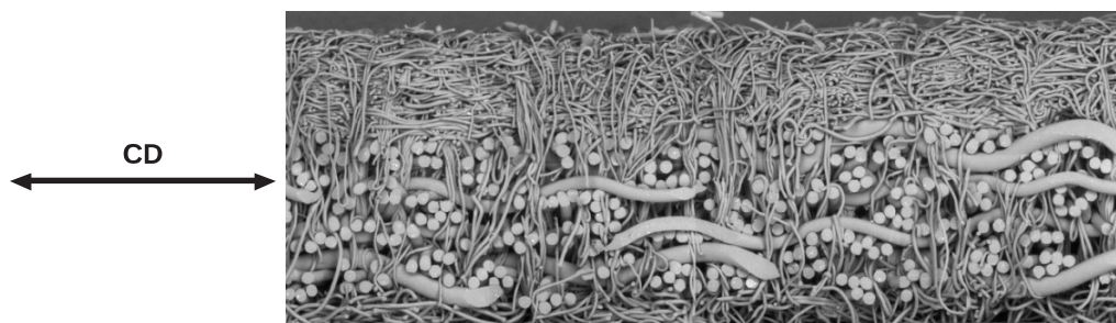
Figura 7: Seção transversal de um feltro acabado.
