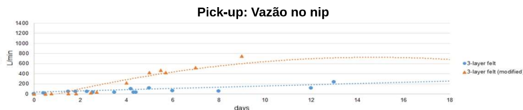
Figura 16: Vazão no nip versus vida do feltro pick-up.
